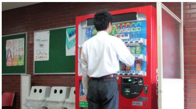
災害時には無償で市民に飲み物を提供 災害対応型自動販売機
