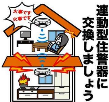
通常の住宅用火災警報器と違い、連動した全ての感知器が一斉に作動するので、より早く火災発生を知ることができます。交換の際には連動型住宅用火災警報器をおすすめします。
