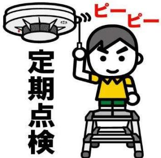
住宅用火災警報器が故障していないか、定期的に作動確認しましょう。テストはボタンを押したり、ひもを引いて点検できます。
