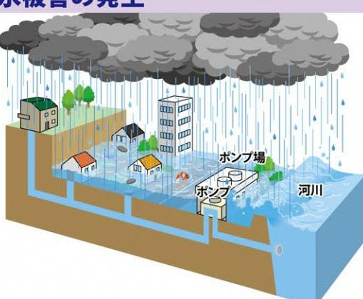
継続的に雨が激しく降り続くなと、雨水管から溢れた水による浸水(ないすい)に加えて、河川から水が溢れたり、堤防が決壊するなどの大きな浸水被害(洪水被害)が発生します。
