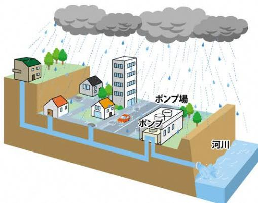
雨が強く降り続くなと、雨水管がいっぱいになって、道路側溝の雨水が雨水管に流れこむことができなくなり、道路上に雨水が溜まりはじめます。
