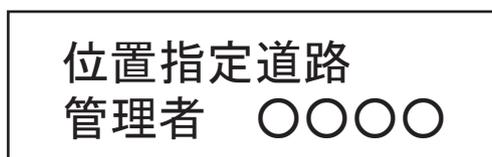
※文字は金属板に彫りこむなど消えないようにし、移動しないようビスなどで側溝に固定すること。
