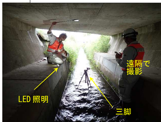
写真 13.19 重要変状の状態把握例（ひびわれ撮影例） ※損傷マーキングはイメージ
