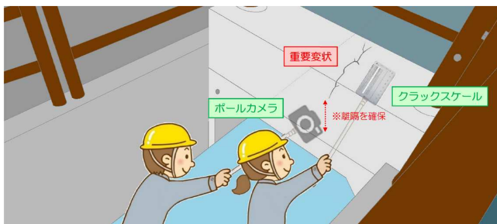
図 10.3 狭隘部での重要変状の記録例
