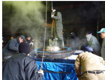
高岡御車山車輪の修理(焼嵌めの様子)
