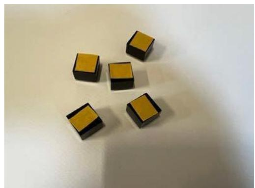
2x2ブロックの底面の両面テープの貼付け例
