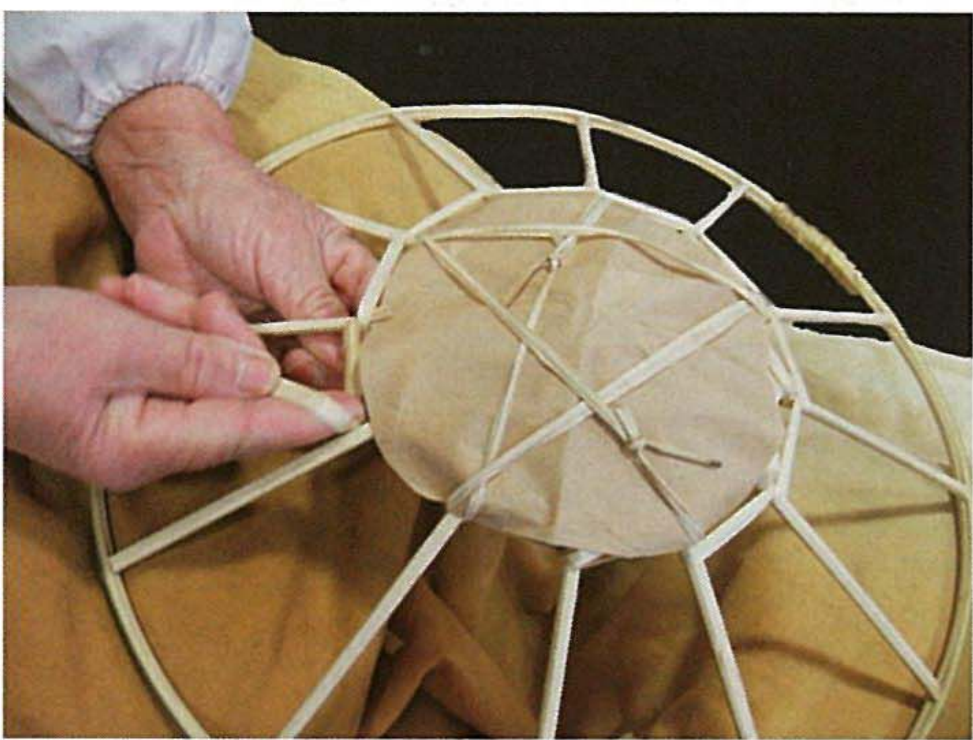
15：続いて、反時計回りに次のナカボネに外側から1周くぐらせ、巻きつける。この工程をガワボネまで繰り返す。
