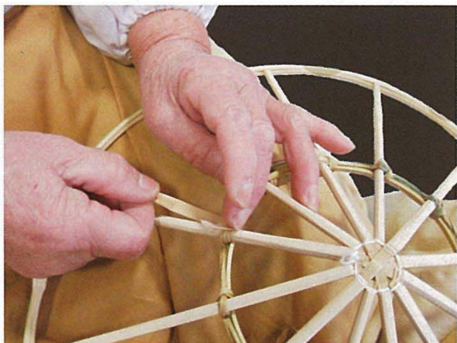
1：シカケスゲを写真のようにナカボネとコガワボネの交点に内側からくぐらせ、一周させ折り返しおさえてとめる（スゲの表が笠の内側になるように）。
