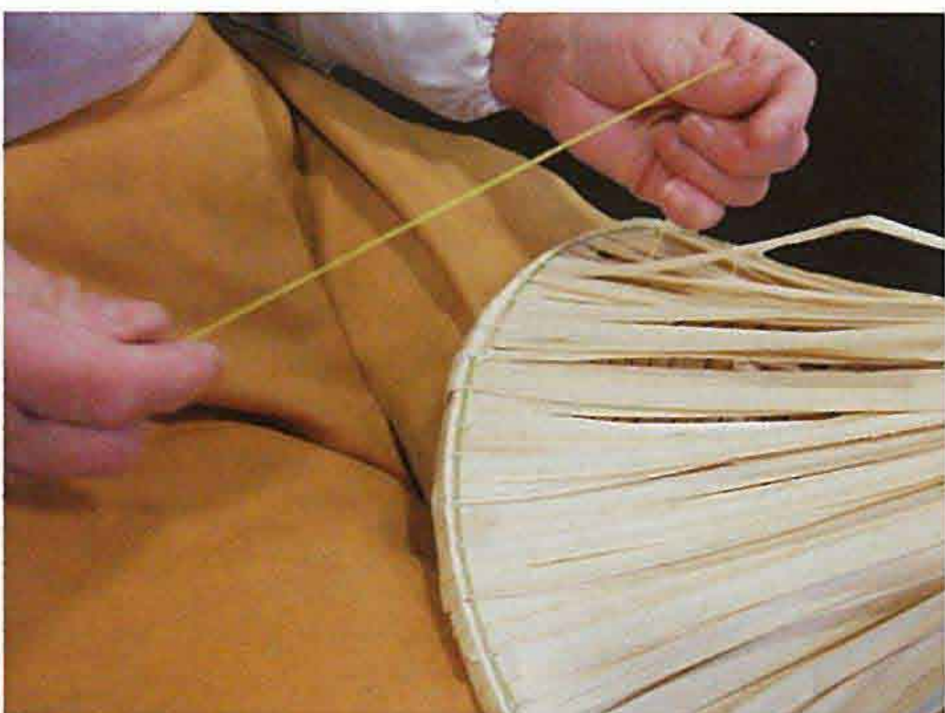
5：結び終えた糸はノズケしたオヤスゲを時計回りに10本ほど進んだところまで、内側に糸をまわす（シカケとオヤスゲの間）。
