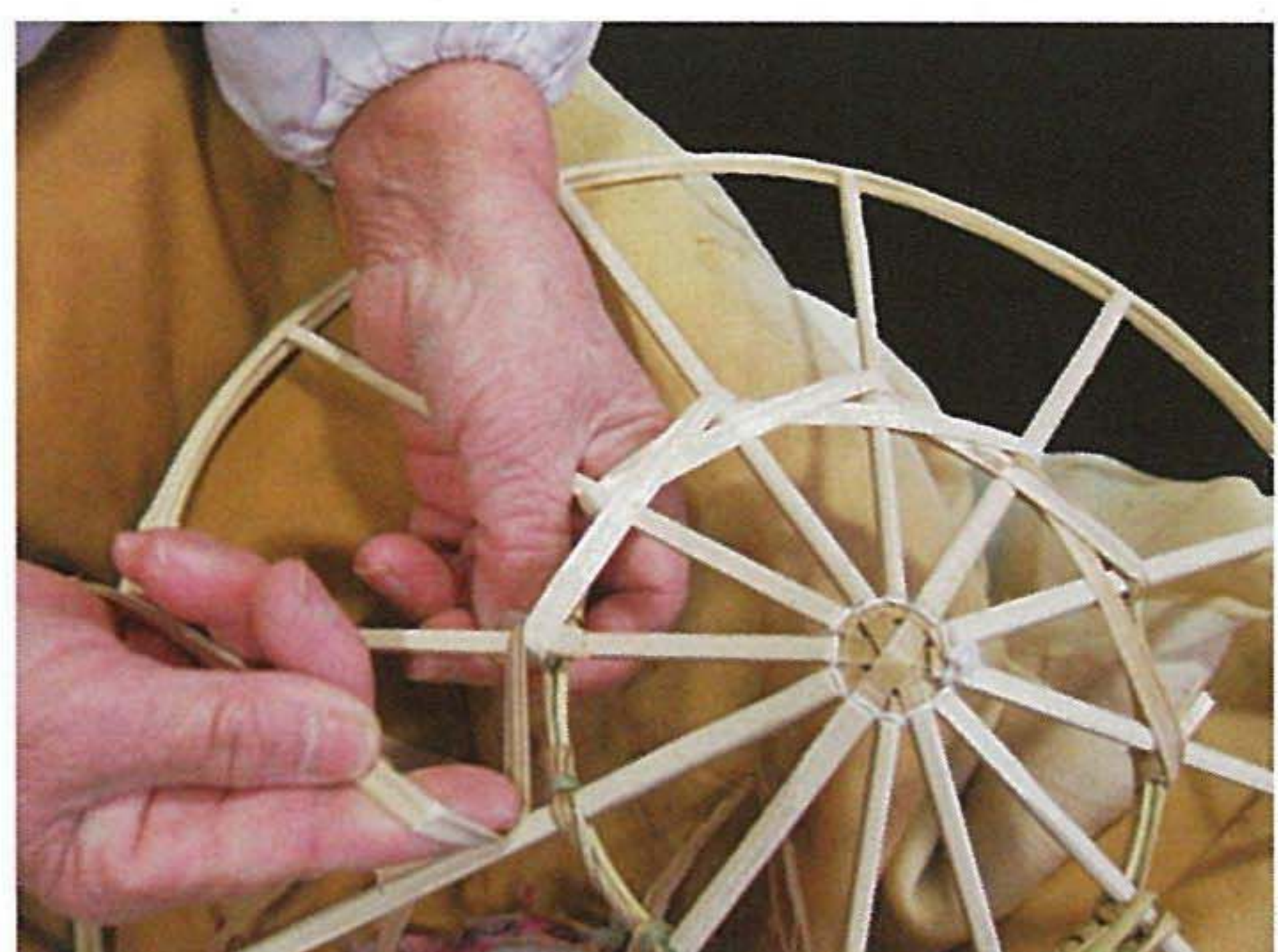
4：シカケ作業工程2から3の作業を繰り返し、コガワボネのまわりに一周させる。
