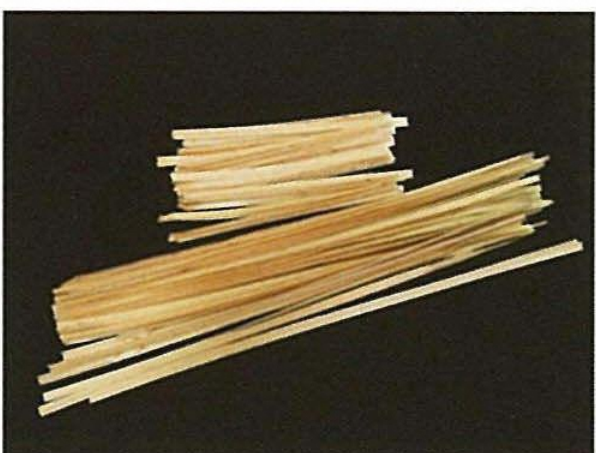
長手は、ガワボネから笠頂部までの2倍+3cmとする。短手は、ガワボネからコガワボネまでの長さ+3cmとする。
