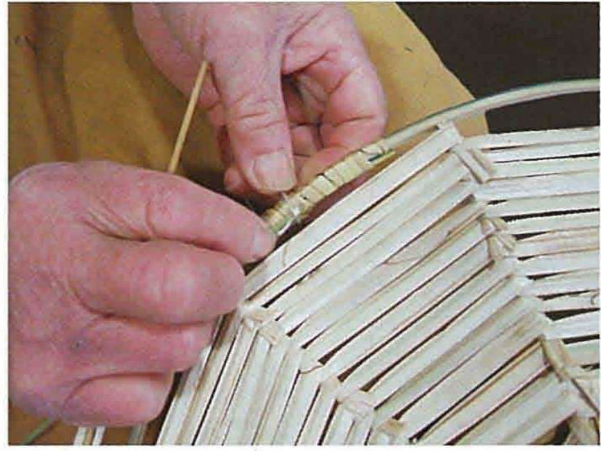
4：コボネに糸を巻きつけ（糸は緩まないようにコボネの根元方向に何度か巻きつけてから先端に向かって巻きつける。）、ガワボネのつなぎ目にあてる。
