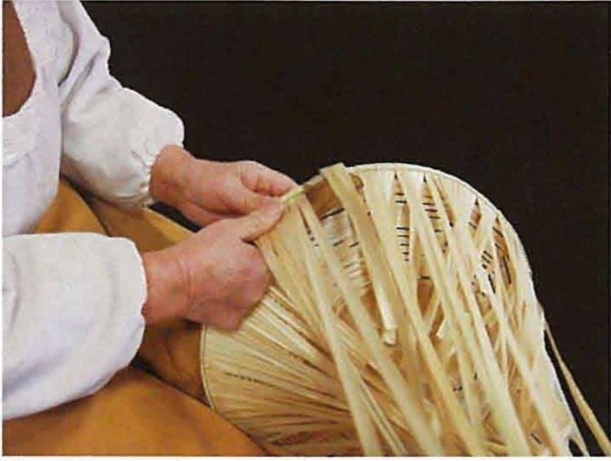
1：ノズケが終わった状態のオヤスゲをガワボネに近い部分から先端に向けて、コキベラを動かし、スゲの表面に光沢をつけ、柔らかくする（内外面ともに）。
