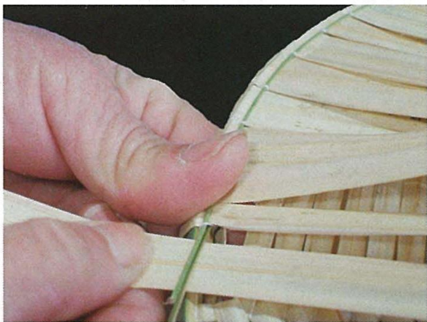
15：次のオヤスゲを挟み折り返す（前の折り返したスゲと一緒に挟み込む）。ノズケ作業工程7～14を繰り返していく。
